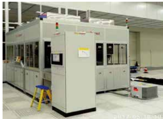
生产现场洁净室小环境的离线 ParticleInspect 解决方案
