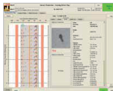
检测复合薄膜上的局部缺陷（上图）和监测材料属性（下图）
